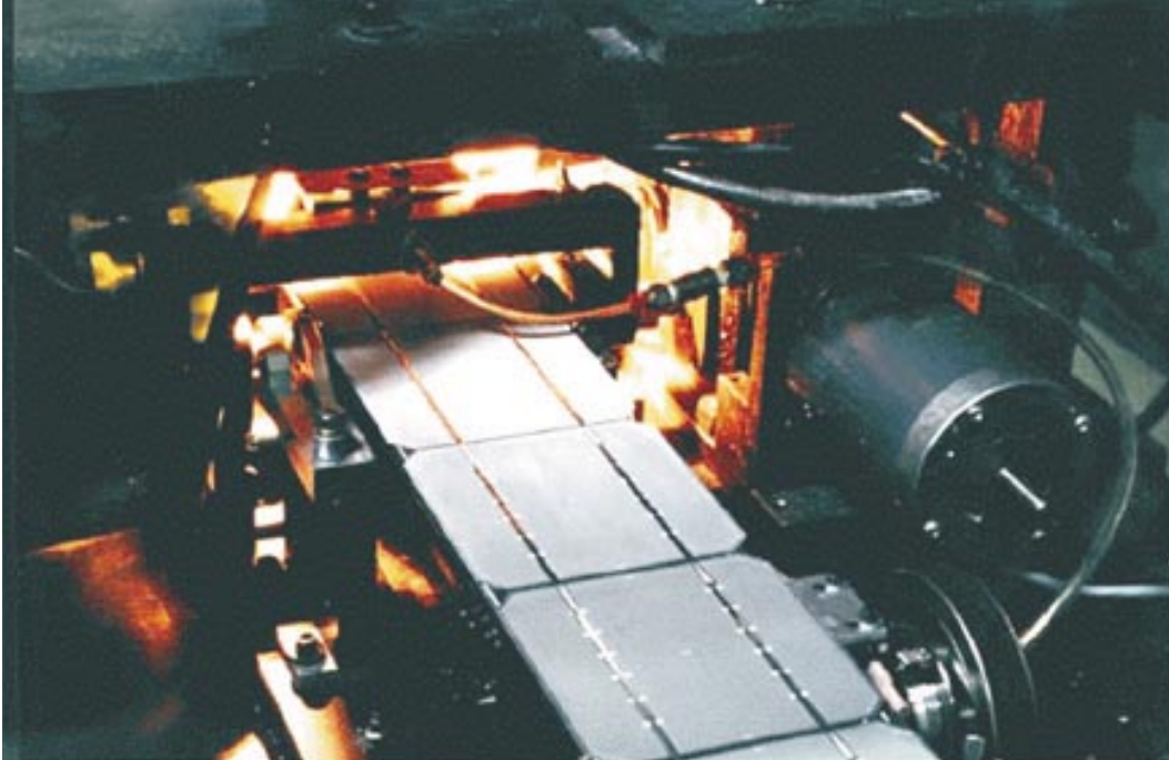
Figura 5. Proceso de soldadura de la rejilla metálica durante el ensamblaje del panel.
