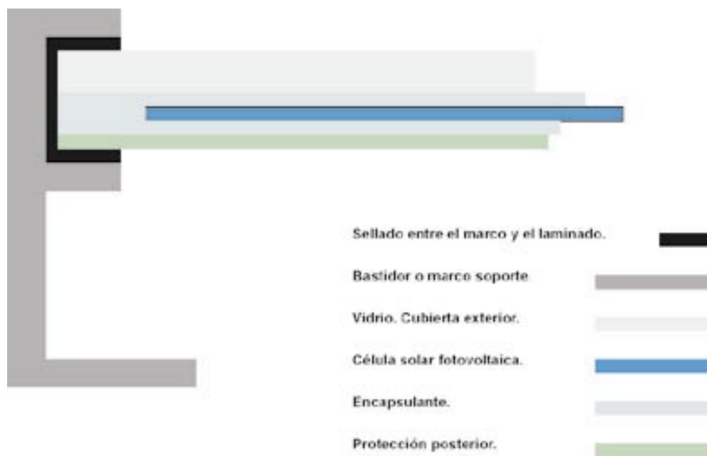
Figura 9. Sección de un panel fotovoltaico.
